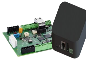
CB energy auf einem EVSE Ladecontroller
